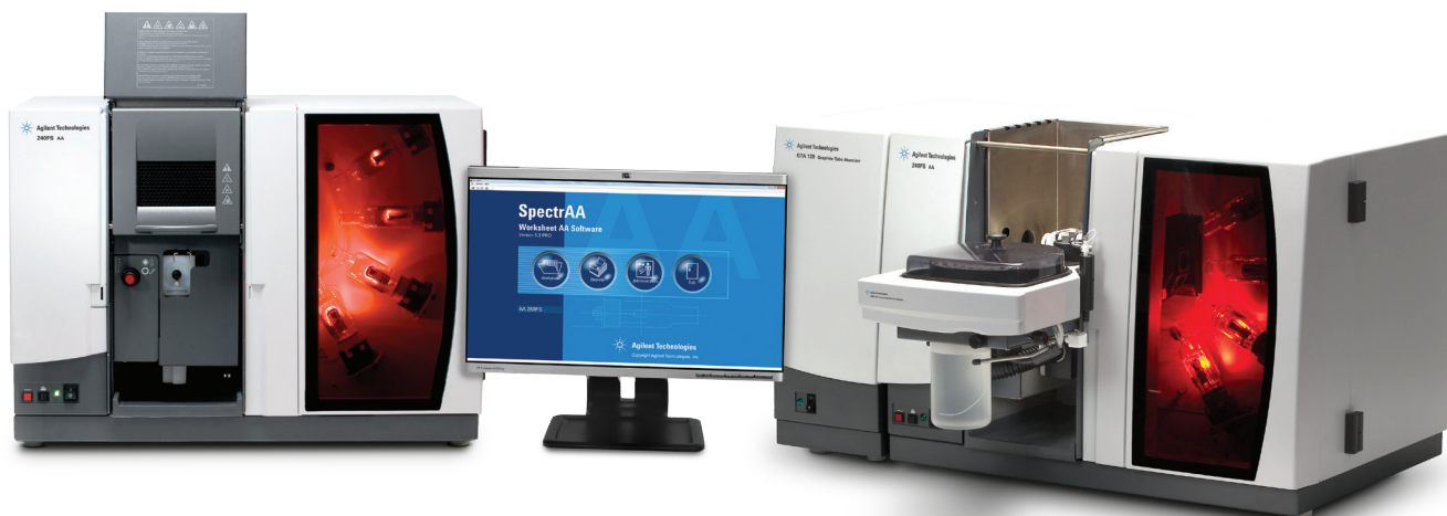
System Agilent Duo – równoczesny płomień i kuweta sterowane z jednego komputera PC
